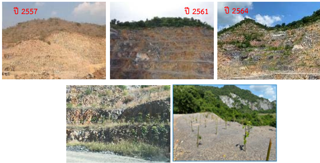
รูปที่ 2.10-5 เปรียบเทียบภาพการปรับชั้นบันไดบริเวณหน้าเหมืองของประทานบัตรที่ 33350/16100
